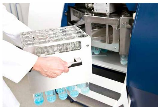
El Kjelttec™ 8400 es un analizador Kjeldahl con análisis volumétrico colorimétrico autolimpiable y muestreadores automáticos opcionales que proporcionan un funcionamiento totalmente autónomo de hasta 60 muestras. Lleve su análisis de las proteínas y el nitrógeno a nuevas cotas de eficiencia con una precisión, una rentabilidad y una seguridad reconocidas.
