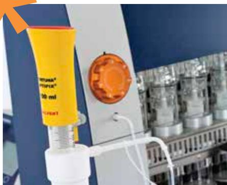
El discado rápido para la adición segura y uniforme de solventes elimina el manejo manual de las sustancias químicas.
