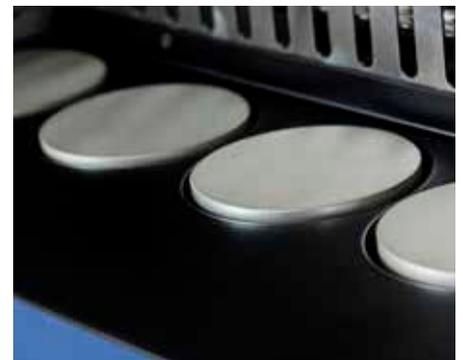
Planchas con control de temperatura individual y función de apagado automático que permite su funcionamiento fuera del horario hábil.
